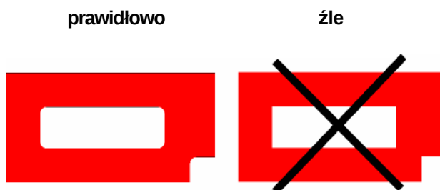
Wycięcia w płycie FunderMax Compact
