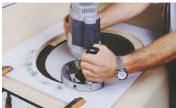
2. Wykonanie przyłgi od strony spodniej kształtki Compactforming przy pomocy frezarki palcowej lub Centrum CNC
