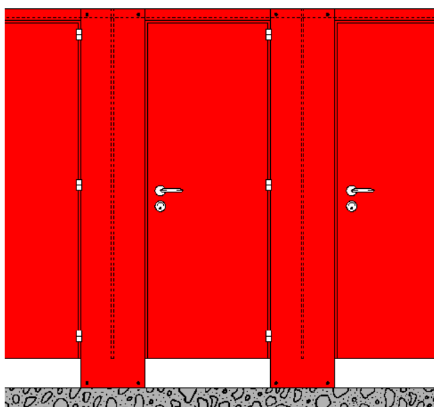
Ścianka frontowa od powierzchni posadzki
